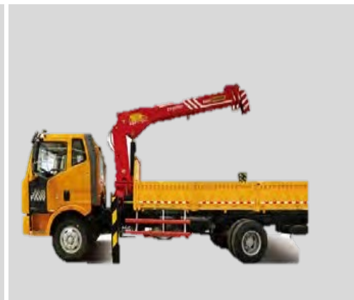
Grue montée sur camion
